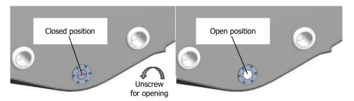
Fig. 4. Hull drain plug.
