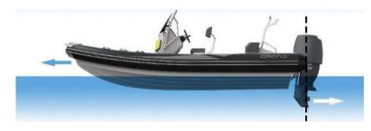
Fig. 22. Optimum trim/motor angle.
