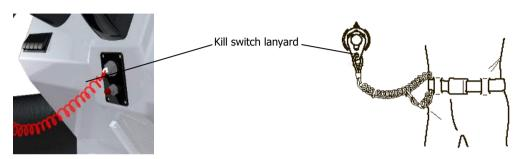
Fig. 26. Engine kill switch lanyard.
