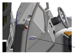
Fig. 30. Electrical horn.
