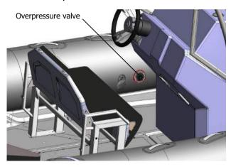
Fig. 21. Overpressure valve.
