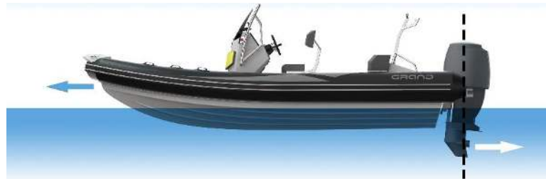
Fig. 22. Optimum trim/motor angle.
