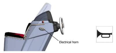
Fig. 26. Electrical horn.
