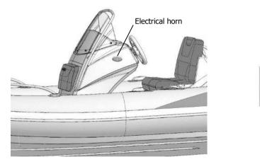
Fig. 26. Electrical horn.
