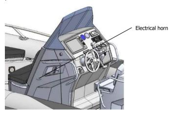
Fig. 29. Electrical horn.
