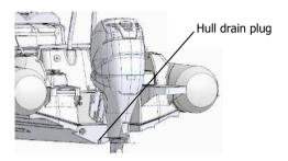
Fig. 4. Hull drain plug.
