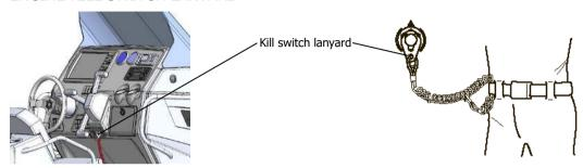
Fig. 26. Engine kill switch lanyard.
